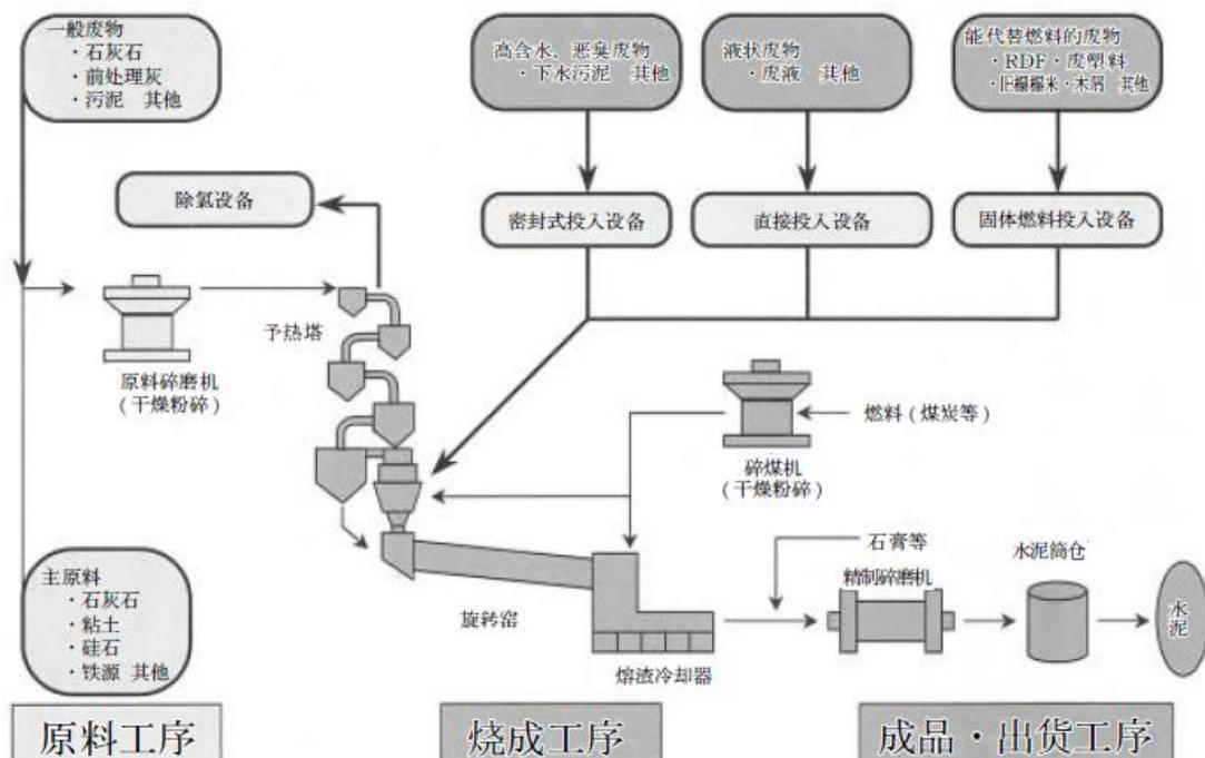
※除氣设备……将影响水泥品质并造成设备故障(阻塞管道等)的气，通过原料预热塔处理，在气化状态下抽出并排除于系统之外的设备。
