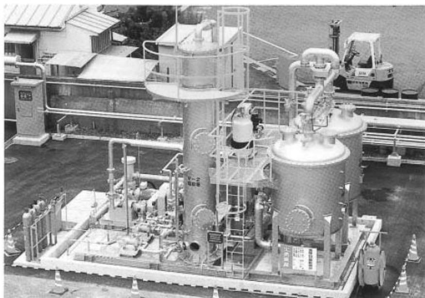
炼油场、油槽所、石油化学工厂等地，在进料、出料、生产过程中，设备运转时会产生碳化氢蒸气，造成污染。这套设备能够防止大气污染并能够高效率回收碳化氢蒸气。此外该设备还能够回收汽油、石脑油、喷气燃料以及溶剂等所含有的碳化氢。
