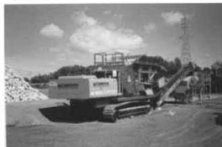
移动式粉碎设备 制造能力 80 - 170T / H 型式 NC 420G
