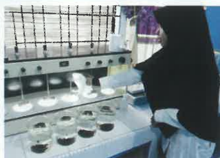
ジャーテスターによる凝集試験を実施しました。
