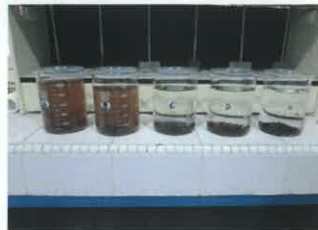
ジャーテストによる実証実験。ラボではPACで指標を達成しました。
